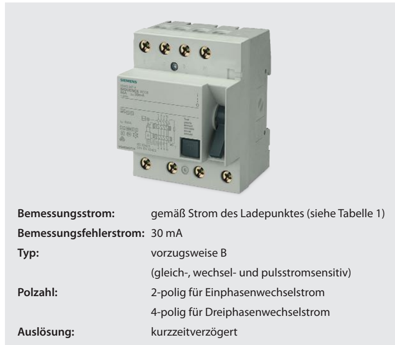
Bild 10: Fehlerstrom-Schutzschalter mit Kenndaten
